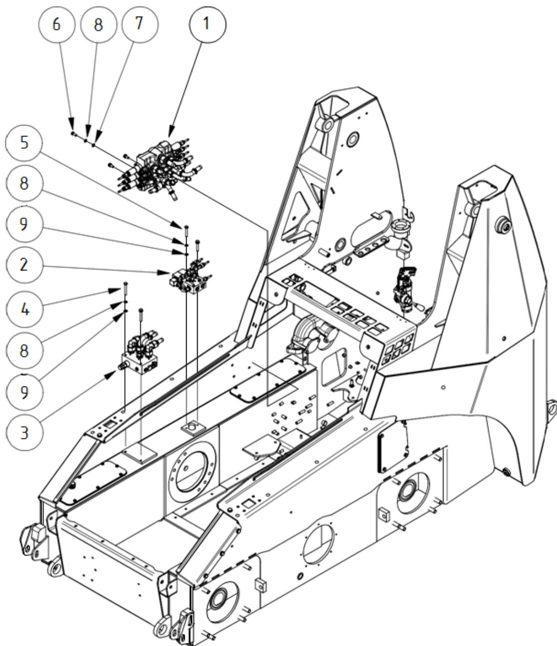
Установка гидрооборудования ANT 1001.67.01.000
