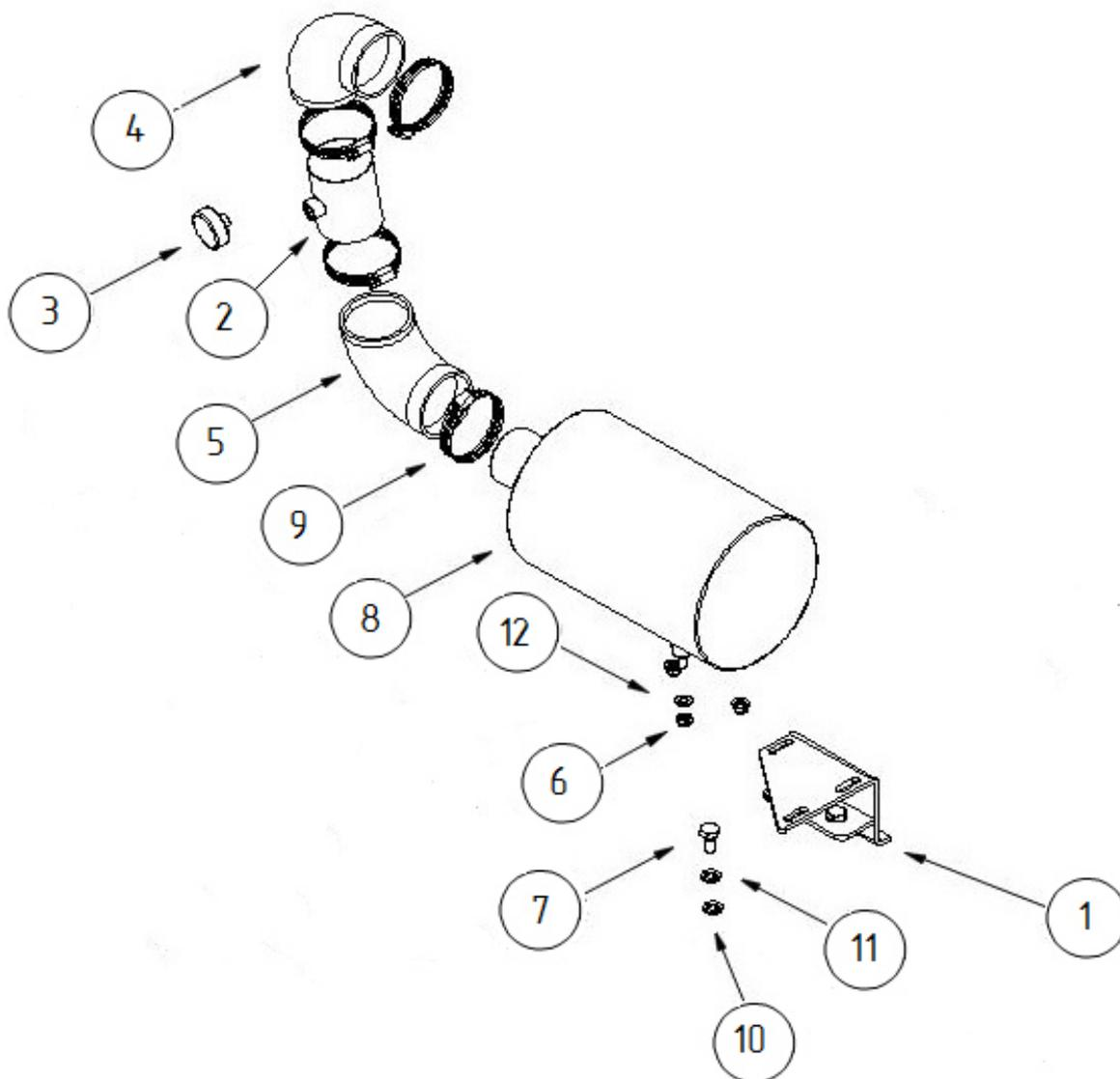
Установка фильтра воздушного ANT 1001.37.04.000
