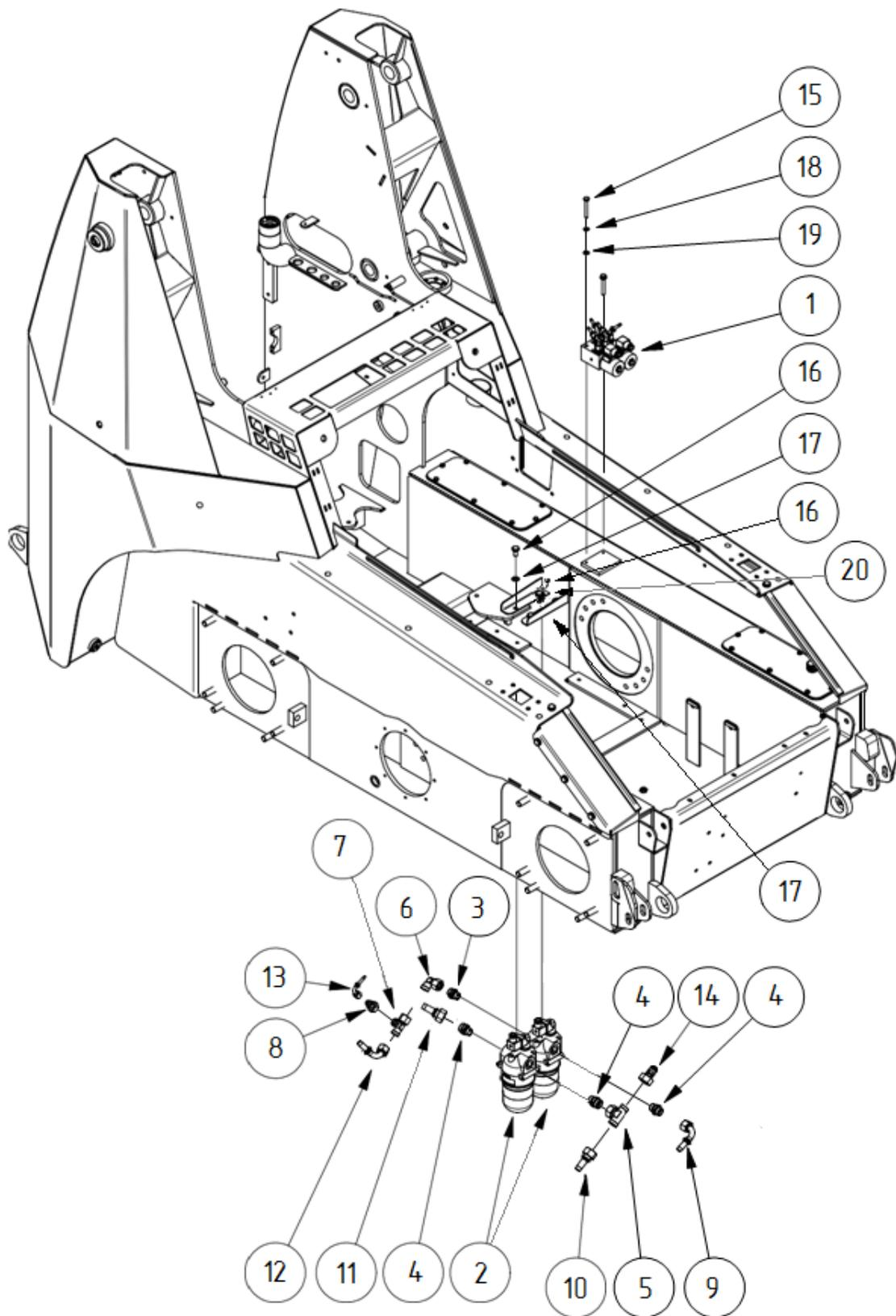
Установка гидрооборудования ANT 1001.67.01.000
